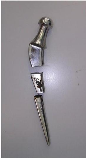
Figure 2 : Fracture d'une tige de Charnley implantée depuis plus de 20 ans.
