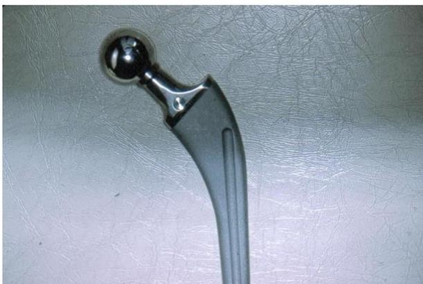
Figure 4 : Tige en titane rugueuse : échecs massifs dus à l'oxydation en surface du titane qui frottait contre le ciment.
