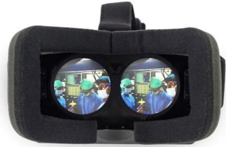
Figure 1 : vue des deux lentilles à l'intérieur d'un masque de réalité virtuelle : une image légèrement décalée est projetée sur chaque lentille, une pour chaque œil, permettant d'obtenir une vision dite stéréoscopique, 3D. Le film initial est enregistré à l'aide de deux caméras.
