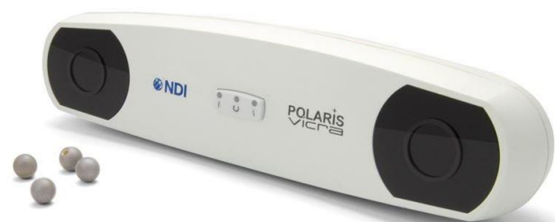
Figure 3 : Localisateur optique (infra rouge) de dernière génération. Les sphères qui sont devant mesurent 1 cm de diamètre. Elles sont recouvertes de microbilles réfléchissantes. Une fois fixées sur leur corps rigide les sphères peuvent être vues par le localisateur.
