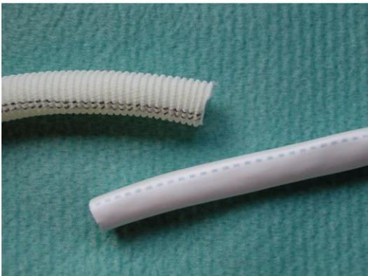
Figure 1 : Prothèses tubulaires en polyester (à gauche) et en PTFE (à droite).
