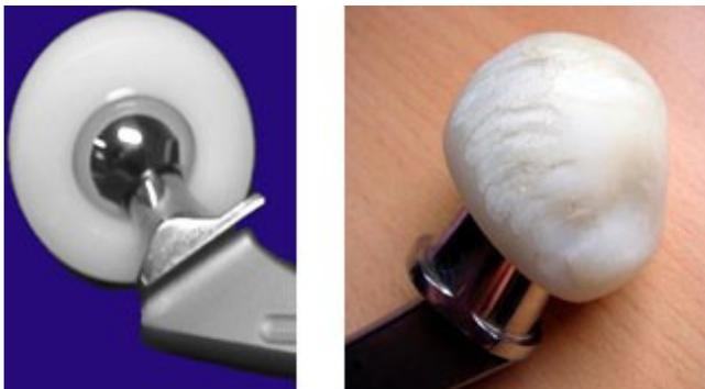
Figure 9 1974, 1er essai cupule DM en PE
