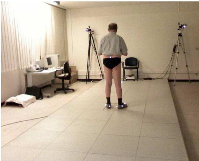
Figure 4 : Analyse du mouvement par système optoélectronique VICON™ et plateforme de force AMTI™. Les marqueurs sur le sujet sont localisés dans l'espace à l'aide des caméras infra-rouges et permettent le calcul des mouvements des segments et articulations.
