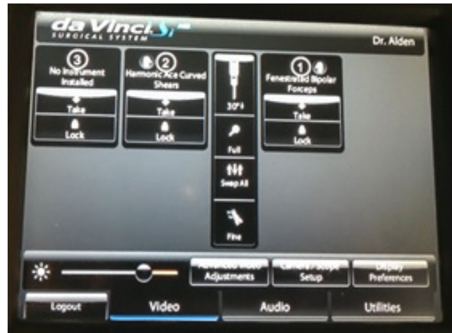
Figure 1 : L'écran de console avec mémorisation du réglage.
