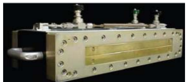
Figure 14 : Détecteur gazeux de Charpak.
