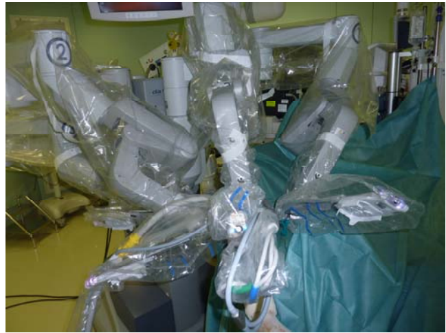
Figure 5. Installation du robot télémanipulateur Da Vinci® en microchirurgie endoscopique pour une chirurgie du plexus brachial. Noter la position originale du bras n°3 dit « opposé » à la caméra, au-dessous du bras n°2.
