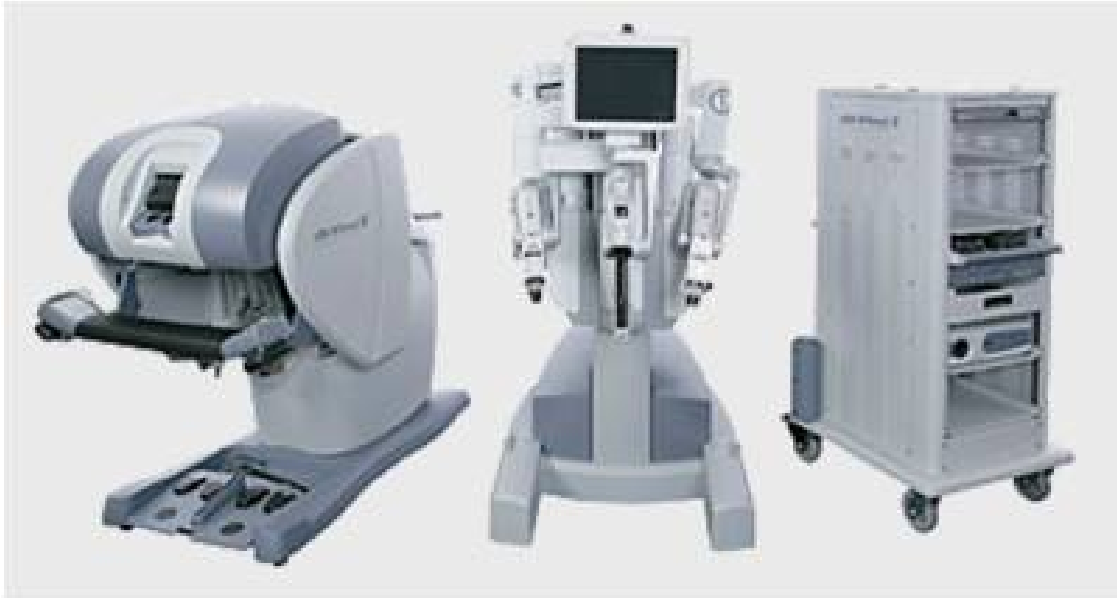
Figure 1. Le robot tétémulateur Da Vinci S® comporte trois parties (de droite à gauche) : un chariot mobile muni de quatre bras articulés, un chariot d'imagerie, et une console permettant au chirurgien de contrôler les bras du robot (avec l'aimable autorisation de Intuitive Surgical™, Sunnyvale, CA, États-Unis).
