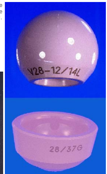
Figure 14. Céramique Alumine/Zircon dite alumine Delta®.
