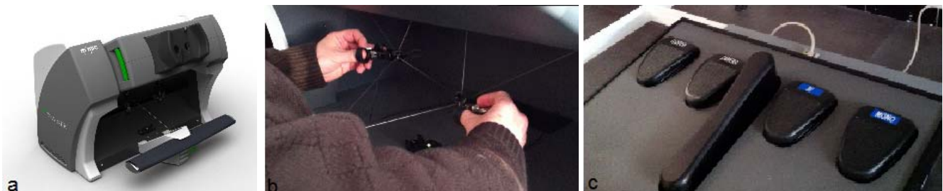
Figure 4. Différents éléments du dV-Trainer® : a. console avec lunettes binoculaires et appui-bras réglables en hauteur ; b. manettes de commande ; c. pédales de débrayage, de contrôle de caméra, de coagulation bi et monopolaire.
