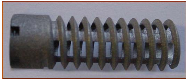
Figure 6 : vue macroscopique d'une cage intersomatique à visser.
