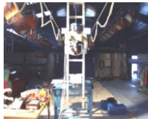
Figure 1 : le puit de chute et le dispositif expérimental. Au centre, mise en place d'un accéléromètre sur le corps de L1 (LBA-UMR T 24 - INRETS)
