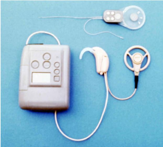
Photo 1. En haut, partie implantable. En bas et de gauche à droite : microprocesseur-boîtier, micro sur contour d'oreille, antenne
